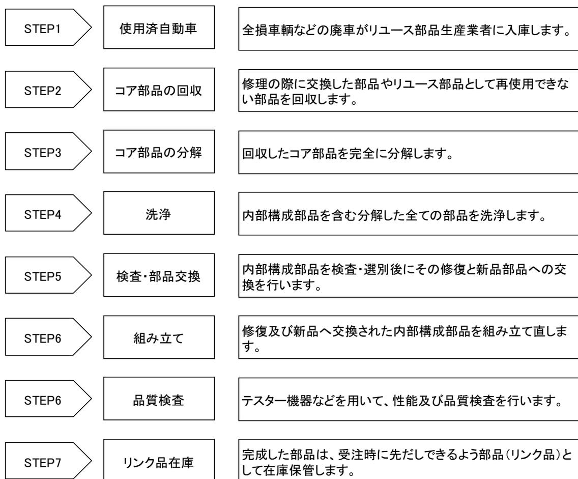
図 2-2 リビルト部品の製造フロー
